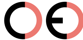
Falsche CE-Kennzeichnung (zu großer Zwischenraum)
